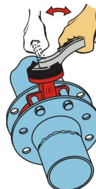
8. Otevřeme průchod klapkou a ověříme, zda je motýl lehce pohyblivý.
